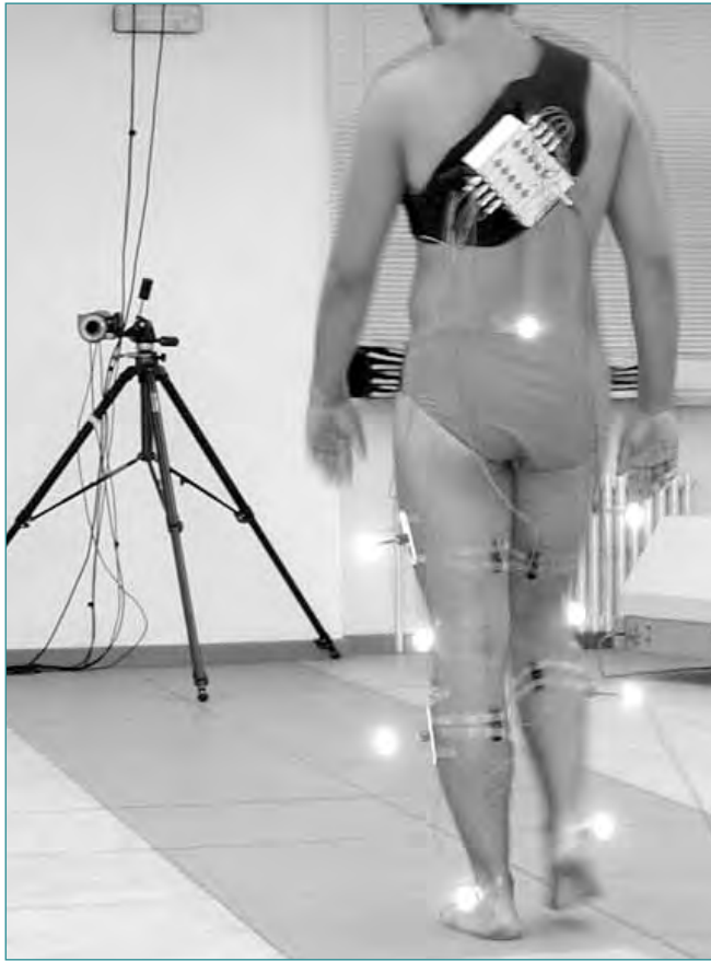
Figura 9. Paciente en estudio con equipo de registro EMG de superficie (Motion Lab.) y marcadores reflectantes. En primer término se aprecia una de las plataformas de fuerza (AMTI), y al fondo una de las cámaras con flash estroboscópico de luz infrarroja.
