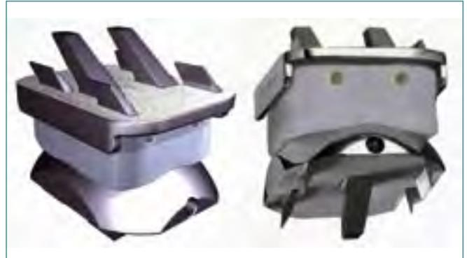
**Figura 1.** Diseño de la prótesis. El componente tibial tiene 2 ó 6 anclajes, según sea cementada o no. Dispone de un carril donde se va a alojar el componente móvil y desplazarse en los movimientos de flexión y extensión. El componente astragalino tiene en su superficie esférica dos radios de giro, uno coronal y otro anteroposterior.
