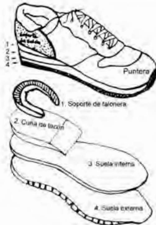
Figura N° 1 Despiece de una zapatilla de corredor.
