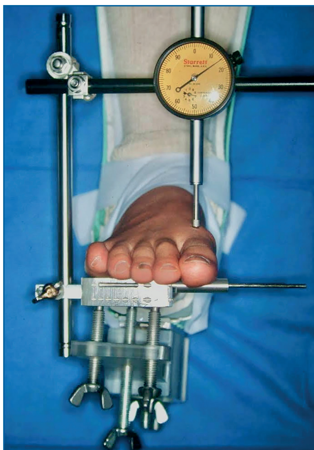
Figura 5. Dispositivo de Klaue para la medición objetiva de la movilidad sagital de la primera articulación tarsometatarsiana. Imagen cedida por cortesía de K. Klaue.
